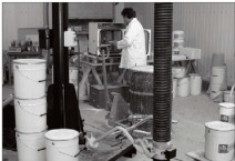
Marc Figoli transforme le calcaire caill en chaux en pâte conditionnée dans des sacs. Une ligne de production simple et ergonomique (grâce à quelques machines) qui laisse toute sa place au savoir-faire artisanal.
